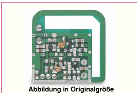
Bild 2: Das kompakte Sendemodul HFS 300. Die Sendeantenne ist als Leiterschleife ausgebildet.
