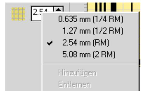
**Bild 6: Die Containerfunktion ermöglicht auch das Abspeichern eigener Leiterbahnbreiten, Rasterweiten und Löttaugenabmessungen.**
