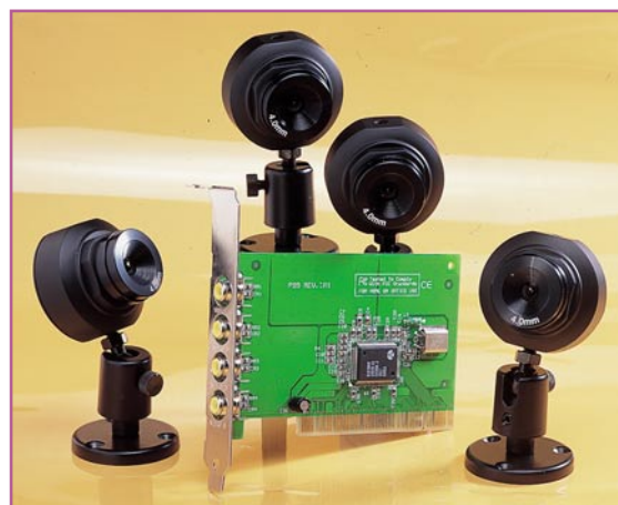
Bild 1: Bereit für den Anschluss von vier Kameras, die ein Composite-Videosignal ausgeben - die Capture-Karte.
