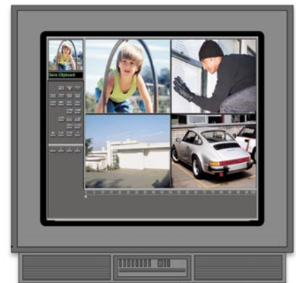
Bild 8: Mit einer Scanfunktion erscheinen alle vier Kamerabilder nacheinander und zugleich auf dem Bildschirm.
