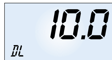
Bild 11: Sturmklingelsperre - hier ist eine maximale Klingelzeit von 10 s eingestellt. Danach schaltet das Relais die Klingel ab.
