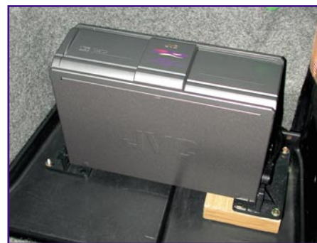
Bild 33: Der montierte CD-Wechsler, noch ohne Abdeckung.
