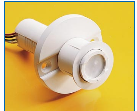
Bild 8: Zur Montage dieses Miniatur-Bewegungsmelders ist nur eine 19-mm-Bohrung erforderlich.
