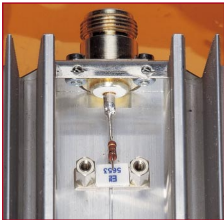
Bild 3: Detailansicht zum Einbau des Chipwiderstandes
