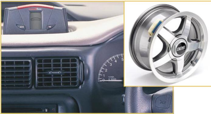
Bild 1: Das drahtlose Reifendruck-Messsystem SMART-TIRE
