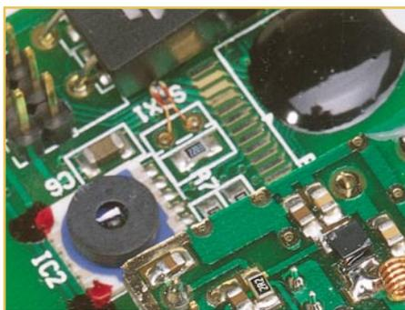
**Bild 13: Moderne piezo-resistive Drucksensoren finden Einsatz in den Innensensoren der ELV-Funk-Wetterstationen**
