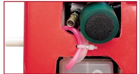
**Bild 5: Hier sind die beiden Tankschläuche gut aufgehoben. Links ist auch der dicke Silikonschlauch zu sehen, der die Abgase nach außen ableitet und so eine Verschmutzung der Karosserie und der Reifen verhindert.**
