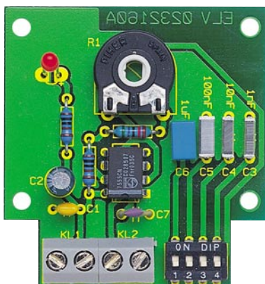
Ansicht der fertig bestückten Platine mit zugehörigem Bestückungsplan
