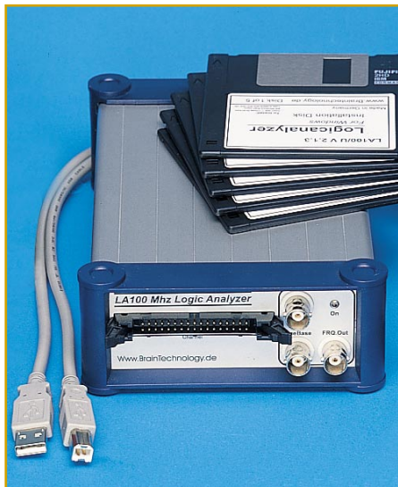
Bild 5: Arbeitet ebenfalls mit einer Version des diskutierten ActiveX: 16-Kanal-/100 MHz-Logik-Analyser LA 100 USB.
