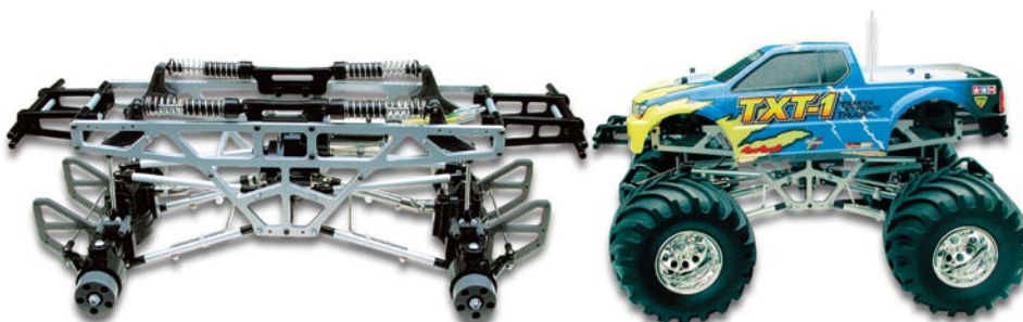
Bild 12: Augenweide - eigentlich zu schade für die Rennbahn. Der Alu-Gitterrahmen des TXT-1
