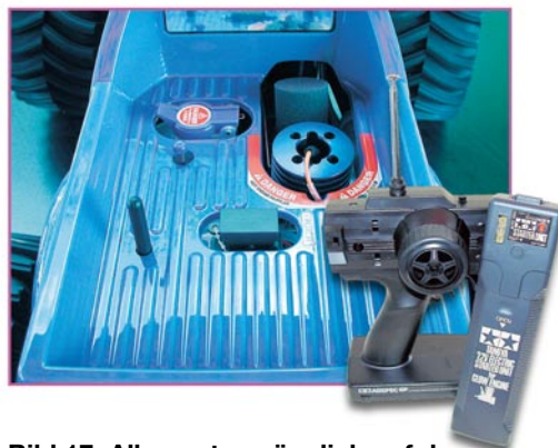
Bild 17: Alles gut zugänglich auf der Ladefläche: Tank, Luftfilter, Glühkerze, Starter-Anschluss. Rechts der Fernsteuersender und die Startbox.
