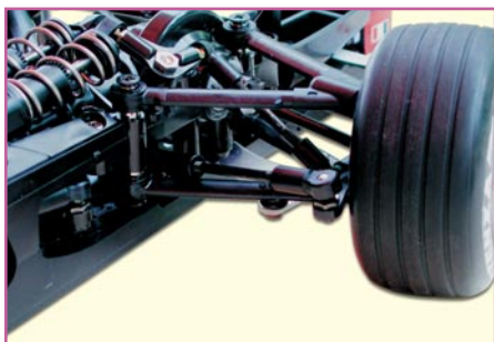
Bild 10: Toller Anblick für Fahrwerks-Enthusiasten - Tamiya hat sich sichtbar bemüht, die filigrane F1-Vorderachse nachzubilden.
