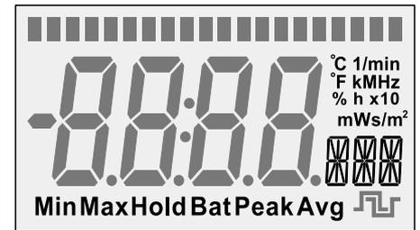
**Bild 6:** Display des Akku-Ri-Messgerätes
