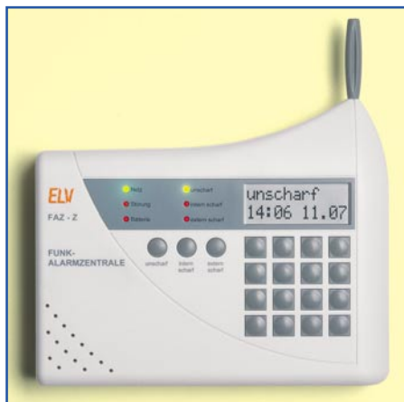
Bild 3: Die Zentrale. Gut zu erkennen: die optisch/funktionell abgesetzten Anzeige- und Bedienfelder
