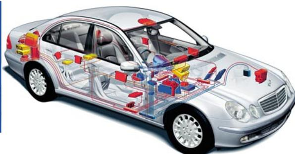
**Bild 1: Mit der zunehmenden Elektronisierung der Fahrzeuge steigt die Zahl der eingebauten Steuergeräte. Je nach Modell gefinden sich dort heute zwischen 30 und 50 solcher elektronischer Einheiten. Bilder: Daimler Chrysler**
