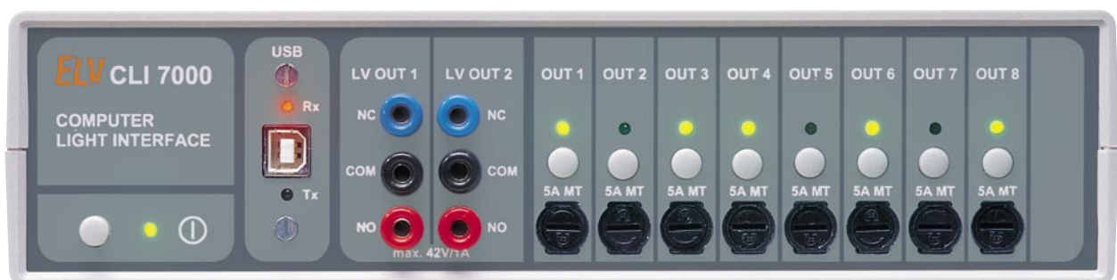
Frontansicht des Computer-Light-Interface CLI 7000
