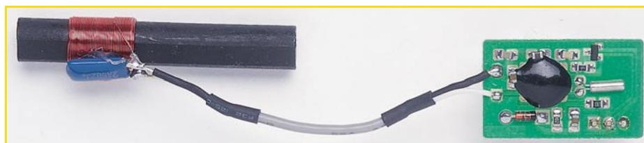
Bild 3: So wird das DCF-Modul vorbereitet
