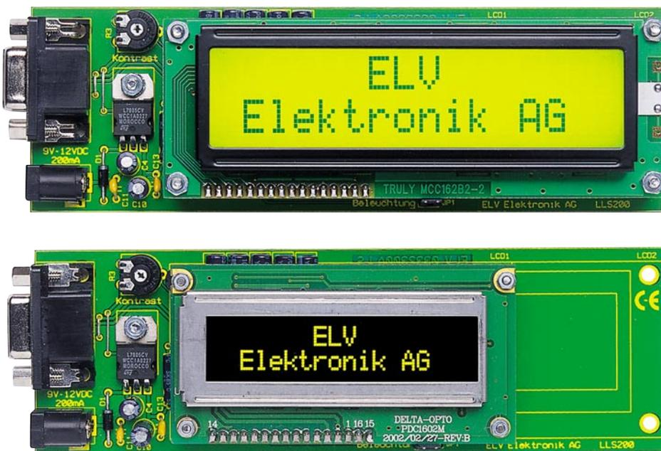
Ansicht der Platine des LLS 200, jeweils einmal bestückt mit LC-Display (oben) sowie mit PLED-Display (unten)
