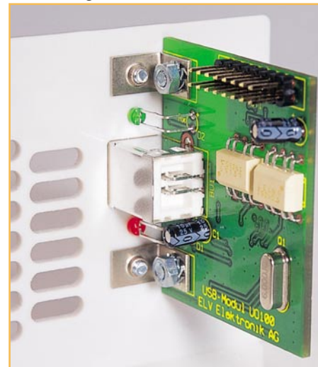
Bild 5: Montagebeispiel des UO 100 in einer Rückwand
