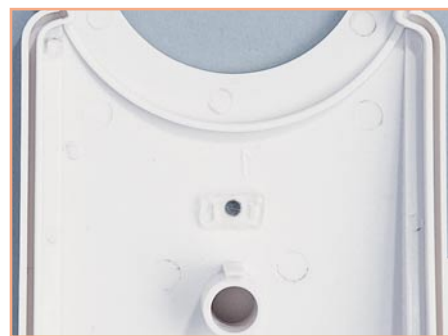
Bild 6: So wird die Lichtleiterkappe von der Innenseite des Gehäuseoberteils her eingesetzt
