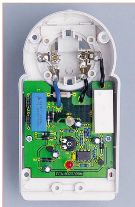
Bild 5: Innenansicht der fertig aufgebauten Schaltung im Gehäuse
