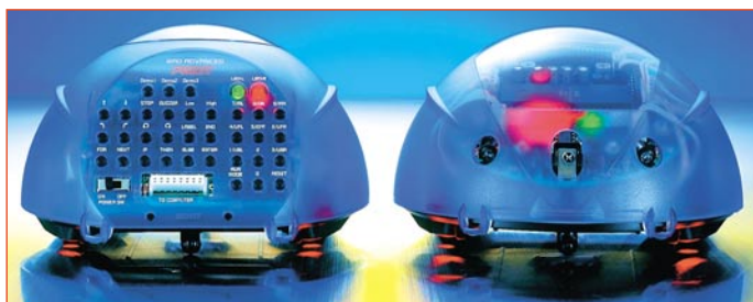
Bild 17: Selbstfahrend und den Weg suchend – der programmierbare Roboter P!MOT. Auf der Rückseite des P!MOT findet man die Tastatur zum Programmieren am Gerät, diverse Anzeigen und die PC-Schnittstelle.
