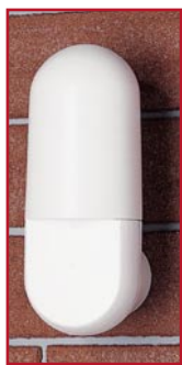
Bild 4: Bis zu 8 Temperatur-/Luftfeuchte-Sensoren ASH 2200 kommunizieren per Funk mit der WS 300.
