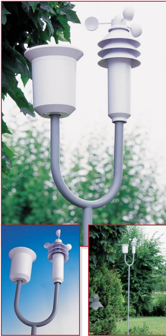
Bild 3: Neuartiger Kombinations-Sensor – der KS 300
