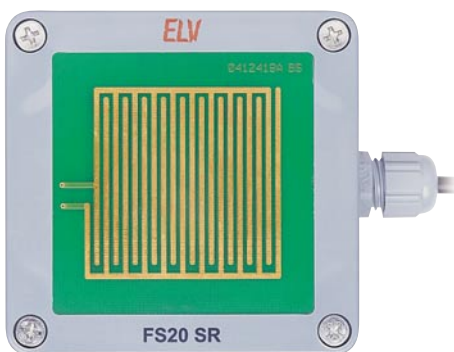
Bild 3: Einbau der Sensorplatine in den Gehäusedeckel
