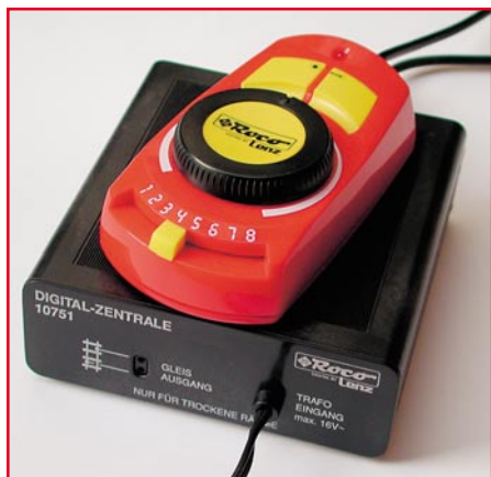
Bild 3: Bis zu acht adressierte Loks lassen sich mit dieser (Einsteiger-) Digitalsteuerung befehlen. Die Lokmaus ermöglicht das bequeme Steuern, ohne an einem Steuerpult sitzen zu müssen. Die Zentrale darunter sorgt für die Bahnstromversorgung und die Einspeisung der digitalen Signale auf das Gleis.
