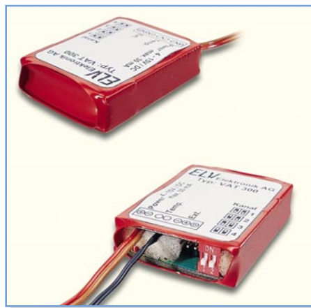
Bild 12: Fertig eingeschrumpfter Telemetriesender VAT 300 (Ansicht von oben und unten)
