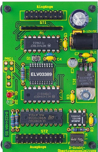
Ansicht der fertig bestückten Platine des Zweidraht-Datenübertragungssystems mit zugehörigem Bestückungsplan
