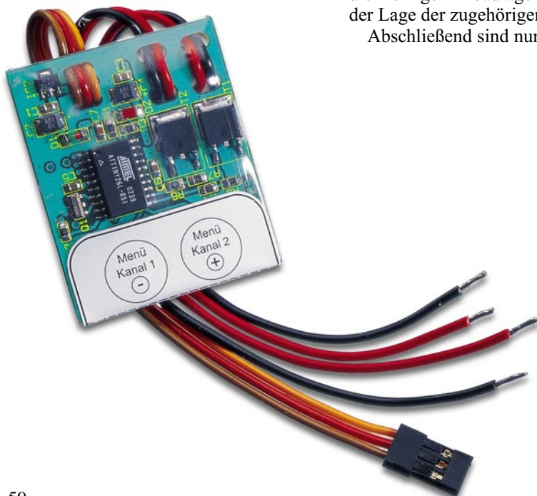
Bild 7: Das fertig in Schrumpfschlauch „verpackte“ Modul, einbaufertig mit Tastenetikett
