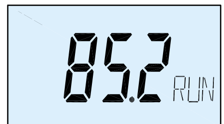
Bild 8: Anzeigebeispiel beim Log-Betrieb; oben links stellt die Bargraphanzeige dar, wie weit der Speicher gefüllt ist, die Digitalanzeige meldet den letzten geloggeten Wert.
