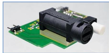
**Bild 26: Montage des Sicherungshalters mit Abstandplatte**
