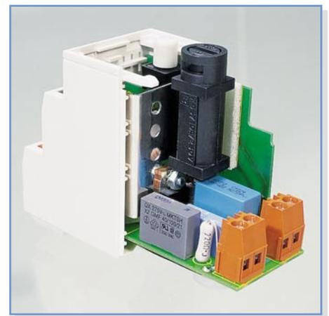
Bild 32: So erfolgt das Einsetzen in das Hutschienengehäuse.
