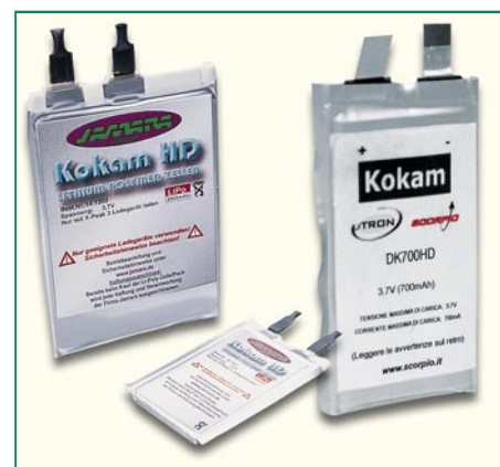
Bild 3: Nur 3 bis 5 mm stark – die superflache und leichte LiPo-Zelle
