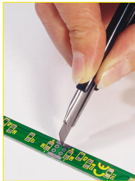
Bild 5: Zum Teilen der Platine sind zunächst auf der Leiterseite die Leiterbahnen mit einem scharfen Messer zu durchtrennen.
