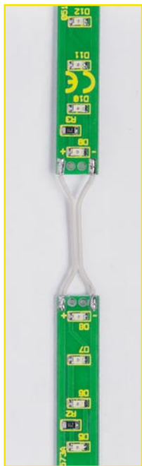
Bild 4: So werden die einzelnen Platinen miteinander verbunden. Wichtig: auf die richtige Polarität achten!
