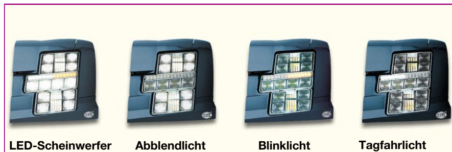
Bild 13: Als Studie funktioniert er schon – Frontscheinwerfer komplett in LED-Technik. Fotos: HELLA
