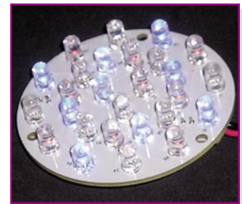
Bild 6: Auf LED-Arrays findet man eine Vielzahl von einfarbigen oder RGB-LEDs, die sich hervorragend für eigene Applikationen einsetzen lassen.
