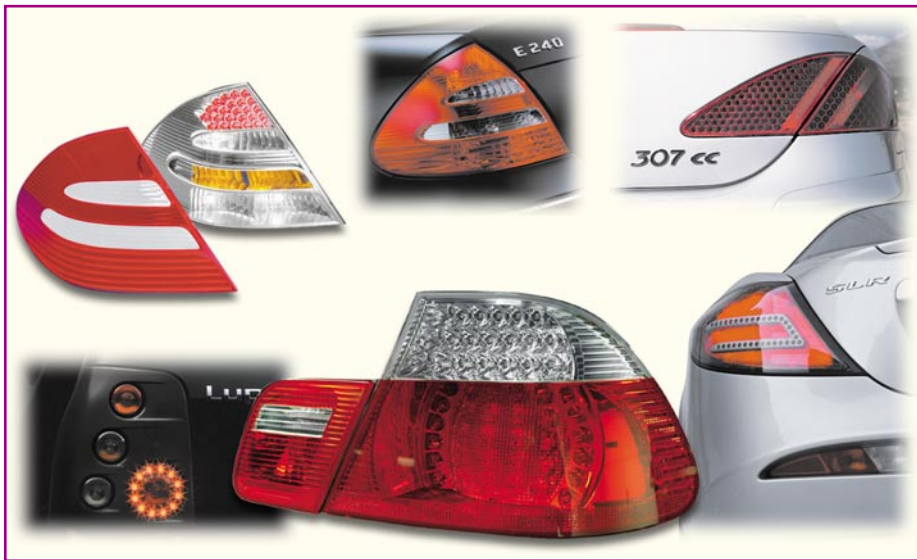
Bild 7: Bei einigen Herstellern schon Stand der Technik – LED-Heckleuchten. Fotos: DaimlerChrysler, HELLA, Peugeot, BMW
