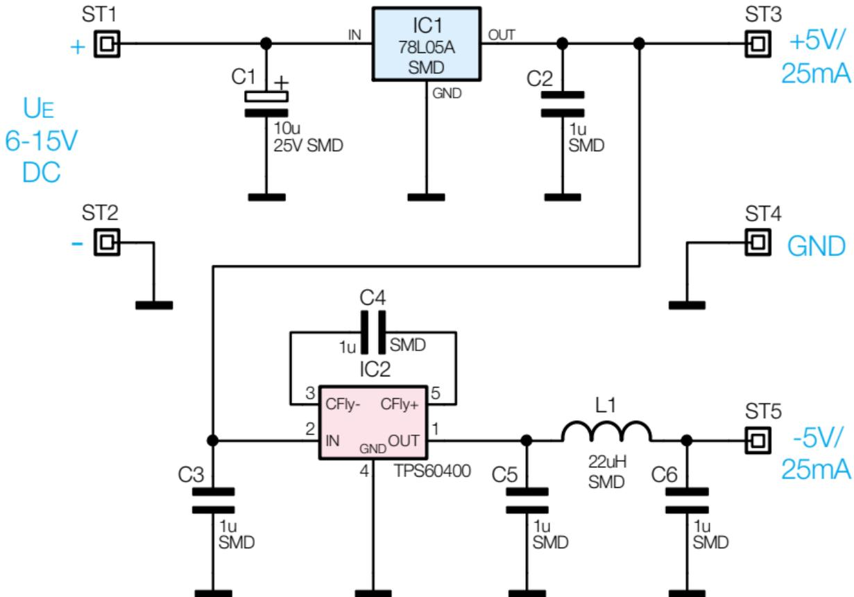
**Bild 1: Schaltbild des Spannungswandlers**
