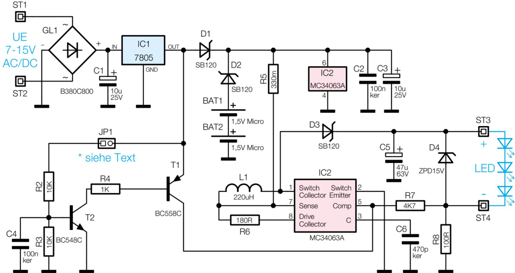
**Bild 2: Schaltbild des LED-Notlichts**
