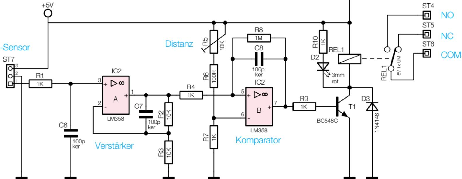
Bild 4: Schaltbild des Infrarot-Distanz-Schalters IDS 80
