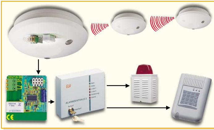
Bild 9: Mit einem Relaismodul gelingt die direkte Anbindung an drahtgebundene Alarmanlagen.
