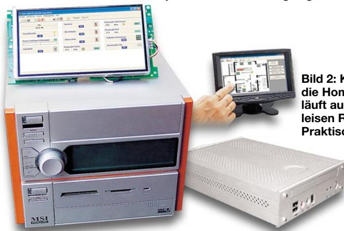
**Bild 2: Kein Großer nötig – die Homeserver-Software läuft auch auf kleinen, leisen Rechnern. Praktischerweise kann die Bildausgabe auf einem kleinen Flachbildschirm (Stand-alone-Gerät oder Einbau-Display) erfolgen.**
