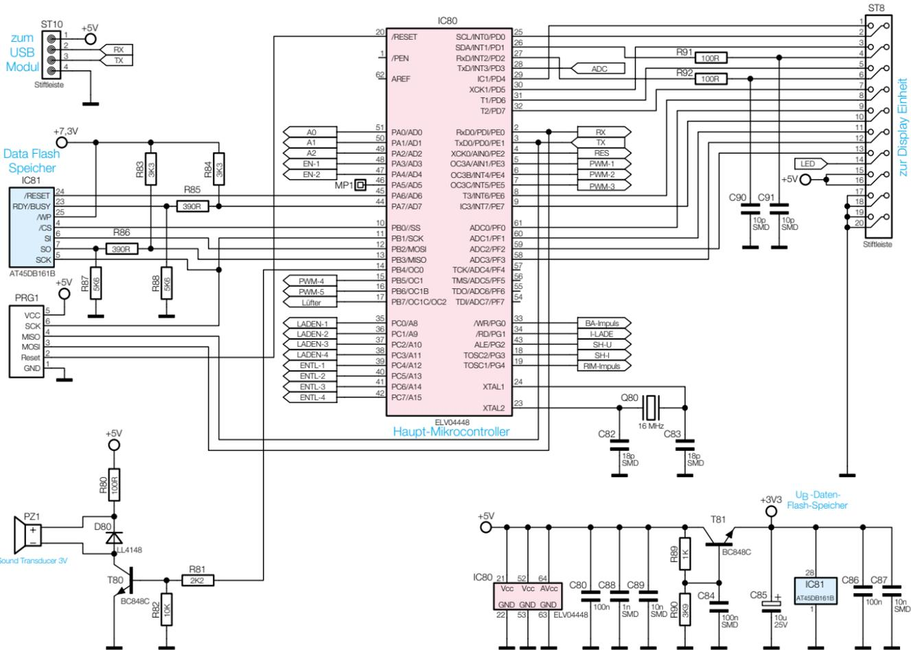
Bild 25: Haupt-Mikrocontroller mit zugehöriger Peripherie
