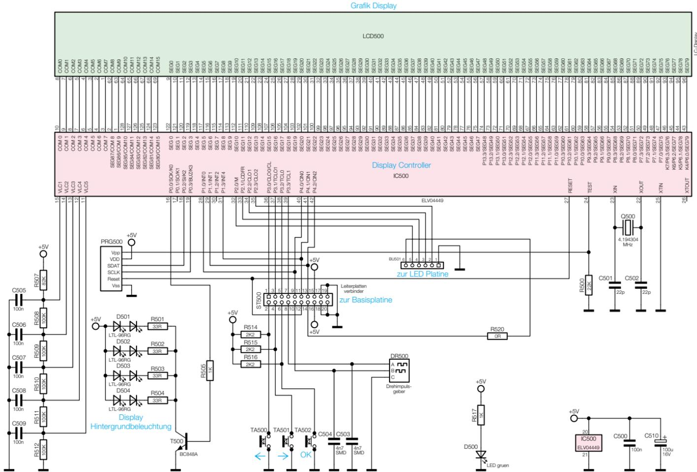
Bild 27: Displayeinheit des ALC 8000 und des ALC 8500 Expert
