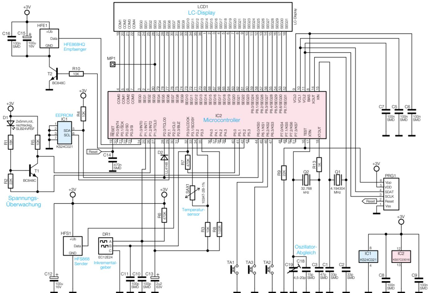
**Bild 4: Schaltbild des Funk-Heizkörperthermostaten FHT 80B**
