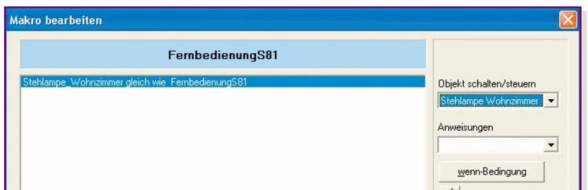
Bild 19: Unser erstes Mini-Makro verknüpft Funk-Schaltsteckdose und Fernbedienung via PC-Interface.
