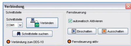
Bild 12: Im Verbindungs-Menü ist die Konfiguration der Schnittstelle sowie der Fernsteuerung des DDS 10 möglich.
