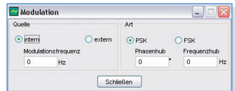
Bild 7: Das Fenster „Modulation“ mit den hier einstellbaren Parametern
