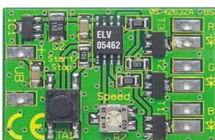
Ansicht der fertig bestückten Platine des RGB-Farbwechslers mit zugehörigem Bestückungsplan
