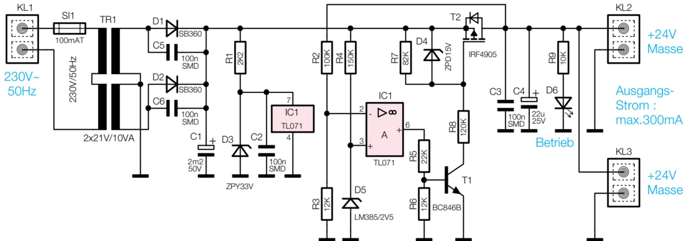
**Bild 1: Schaltbild des Hutschienennetzteils HS485N**
