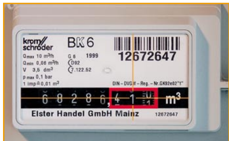
Bild 2: Zielkreuz zur Markierung der Zahlenscheibe der Gaszähleruhr
