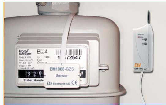
Bild 3: So erfolgt die Fixierung des Sensors auf der Gaszähleruhr. Hier sieht man auch die Führung der Verbindungsleitung zum Sender und dessen Montage in der Nähe der Gaszähleruhr.
