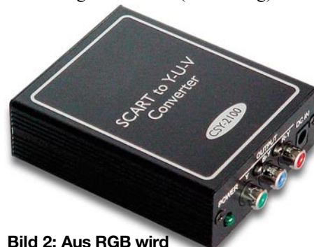
Bild 2: Aus RGB wird YUV. (Quelle: www.converters.tv)
