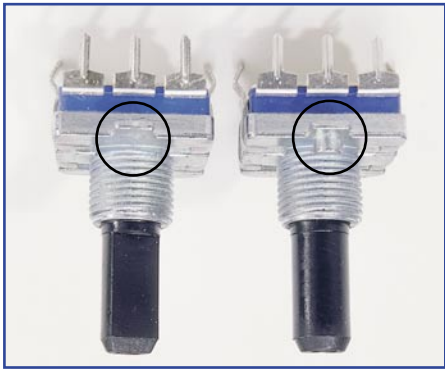
Bild 47: Die Führungsnase des Inkrementalgebers (rechts) wird abgeschnitten (links).
