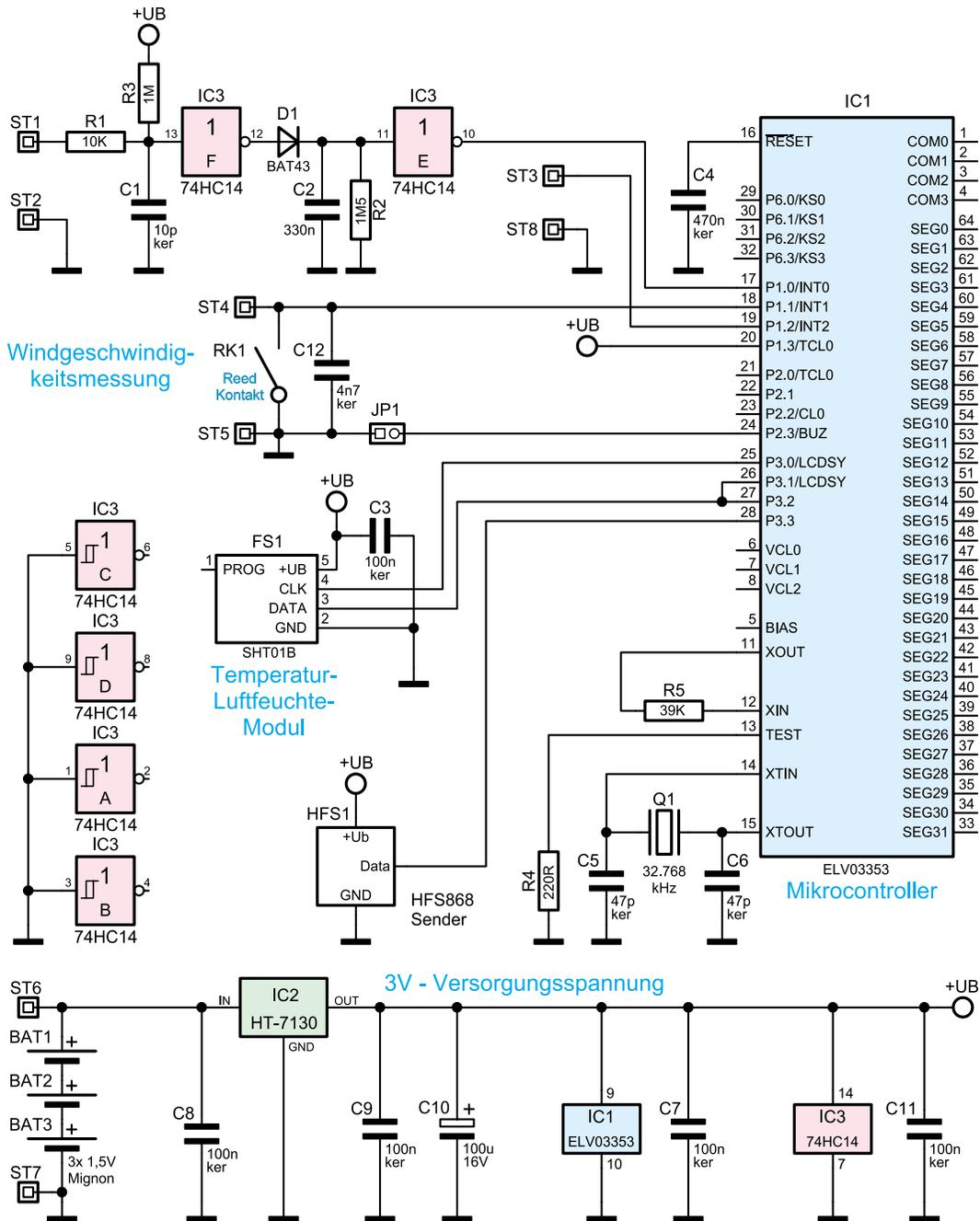
**Bild 10: Schaltung des Kombi-Außen-sensors KS 200**
