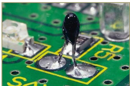
**Bild 5: Sensor zur Temperaturmessung**
