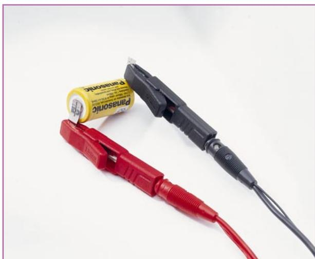
**Bild 6: Anschluss des HET 20 bei Akkus mit Lötflanke**
