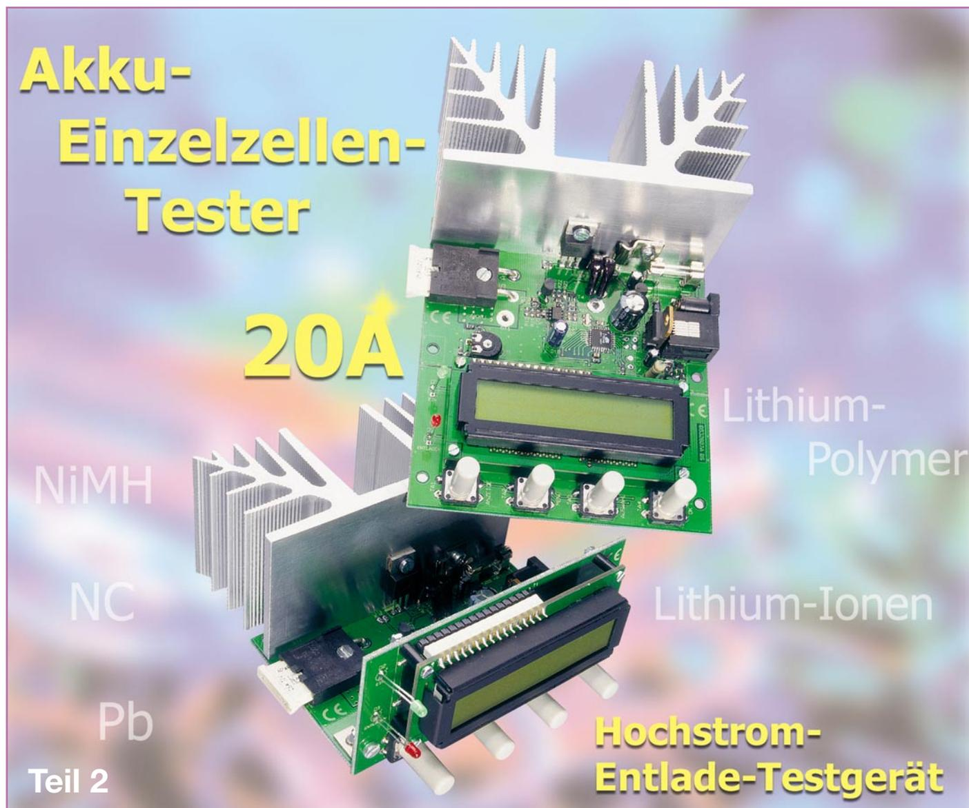
**Mit dem HET 20 ist die Kapazitätsmessung von Einzelzellen mit bis zu 20 A Entladestrom und somit unter realistischen Einsatzbedingungen möglich. Unterstützt werden alle wichtigen Akku-Technologien wie NC, NiMH, Blei-Säure, Blei-Gel, Lithium-Ionen und Lithium-Polymer.**
