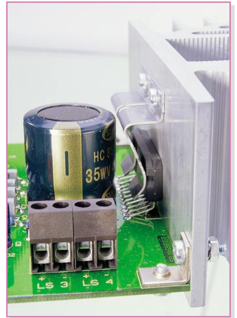
Bild 4: Foto vom montierten Kühlkörper
